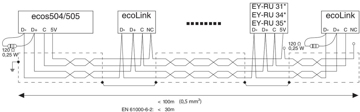
de Bei Verwendung von EY-RU 31\*/34\* darf die gesamte Buslänge max. 30 m sein, um EN61000-6-2 zu erfüllen. Falls EN61000-6-2 nicht gefordert ist darf die Buslänge max. 100 m sein. (Kabelquerschnitt  $\geq 0,5 \text{ mm}^2$ )
