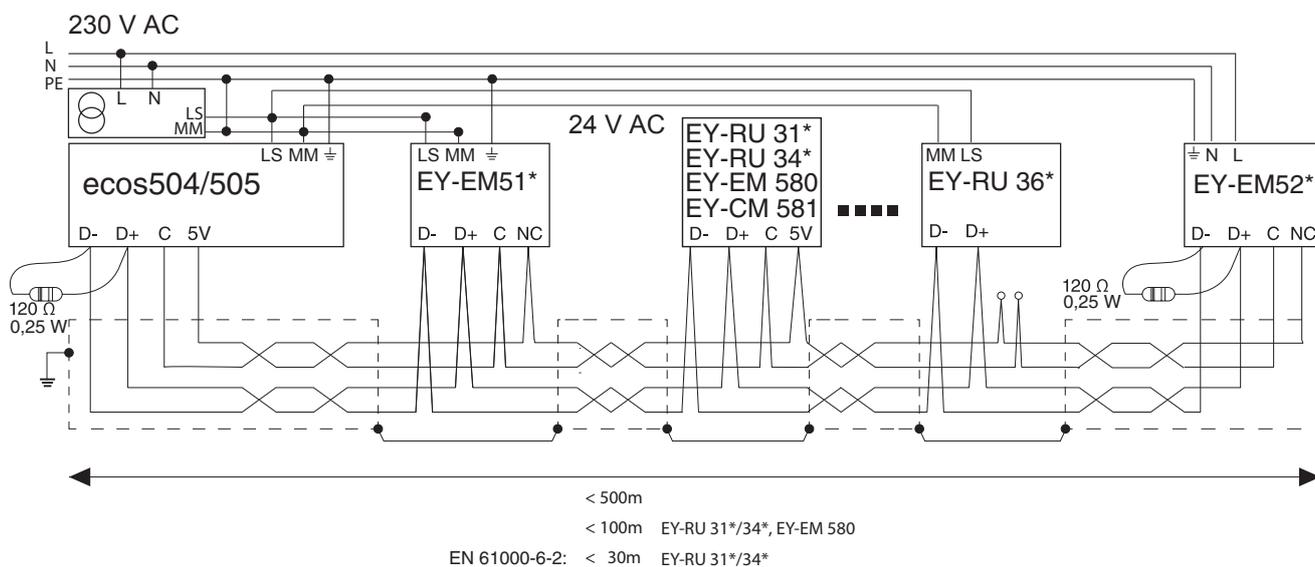
de Bei Verwendung von EY-RU 31\*/34\* darf die gesamte Buslänge max. 30 m sein, um EN61000-6-2 zu erfüllen. Falls EN61000-6-2 nicht gefordert ist darf die Buslänge max. 100 m sein. (Kabelquerschnitt  $\geq 0,5 \text{ mm}^2$ )
