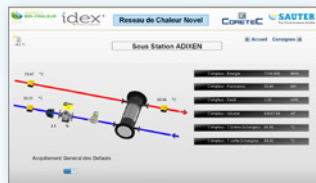
Visualisation d'une sous-station et de ses principales valeurs de compteur (notamment énergie, pression, quantité d'eau ou température).
