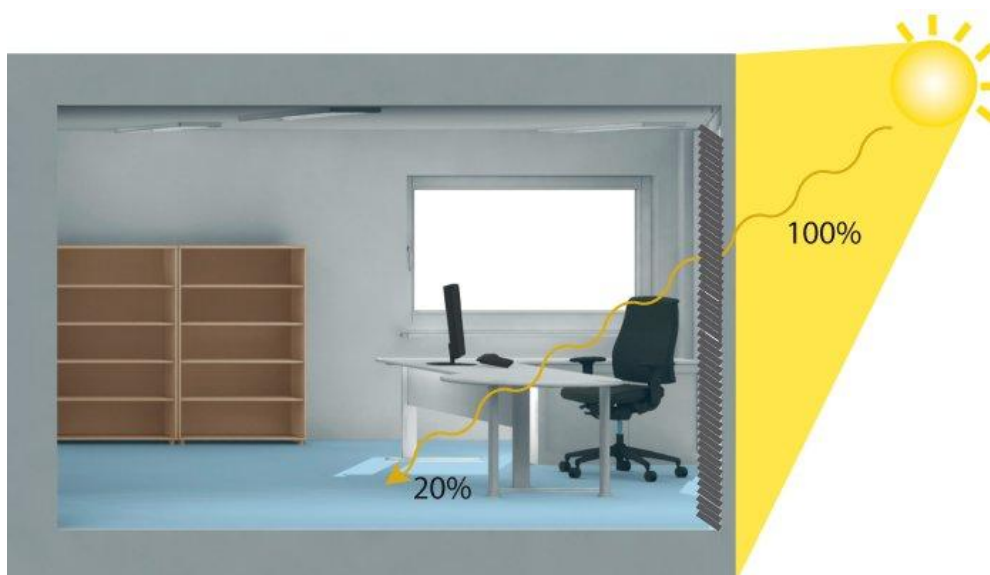
Fig. 1 : Réduction de la pénétration de la chaleur de 80 % grâce à la protection solaire
