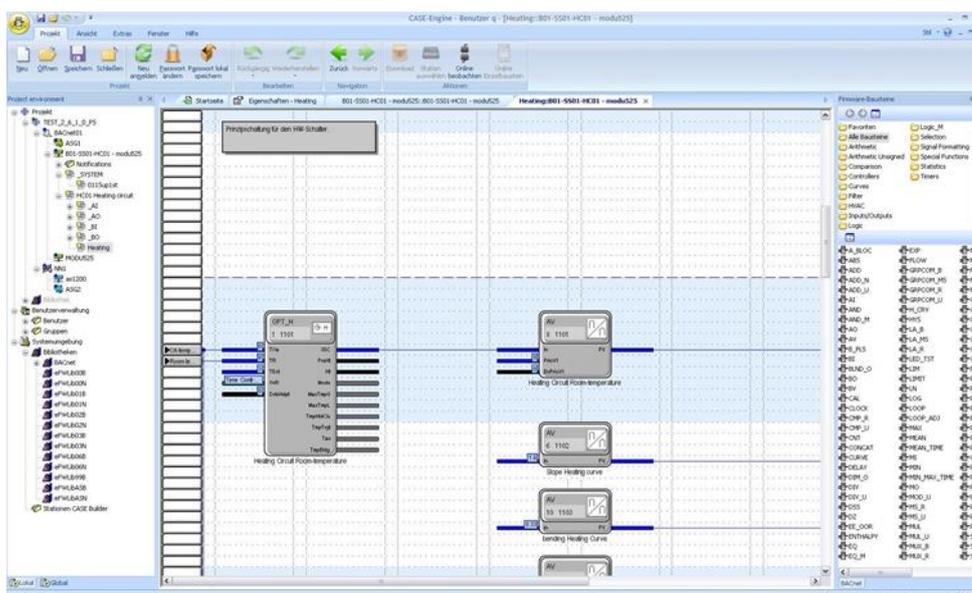
Mit dem Editor von CASE Engine und der **integrierten Bibliothek** erstellen Sie im Rahmen eines Projekts innerhalb kürzester Zeit Grafiken für die **systemspezifische Automationsstations-Software**. Auf diese Weise lassen sich **Funktionspläne** erstellen
