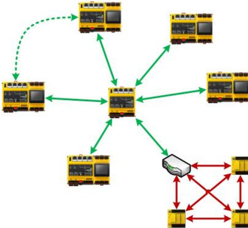
Abbildung 4 Hub-und-Spoke-Topologie von BACnet/SC. Während die BACnet/SC-Kommunikation im Hub zentralisiert wird, erfolgt die BACnet/IP-Kommunikation zwischen den einzelnen Stationen («Station to Station») oder mittels Broadcasting.
