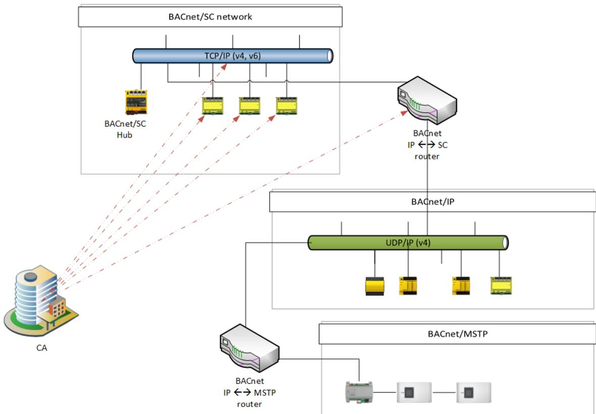
**Abbildung 3** Verschiedene BACnet-Netzwerke und -Geräte
